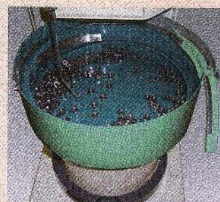
■ナット選別用ボウル(ボウル径φ300) ※φ300ボウルは裏ナット回収機構付です Nuts selection bowl (Bowl diameter 300mm) ※300mm diameter bowl has the mechanism collecting the back nuts.
